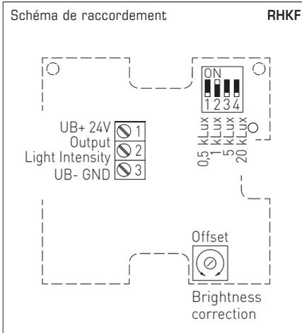
**PHOTASGARD® RHKF** Sonde de luminosité ambiante
