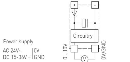
Если для питания нескольких приборов используется напряжение 24 В **переменного тока**, необходимо следить за тем, чтобы все положительные входы рабочего напряжения (+) полевых устройств были соединены друг с другом. Это относится также ко всем отрицательным входам рабочего напряжения (-) = опорного потенциала (синфазное подключение полевых устройств). Все выходы полевых устройств должны относиться к одному потенциалу!
