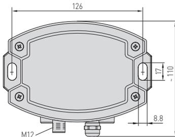
Gehäuse mit **M12-Steckverbinder**
