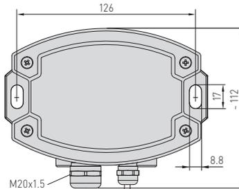
Gehäuse mit **Kabelverschraubung**
